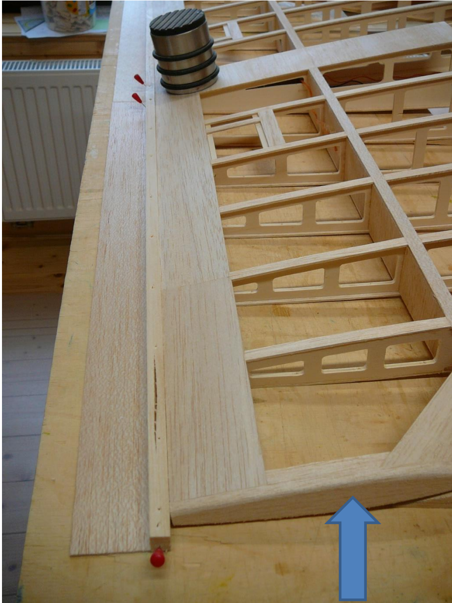
Randbogen Balsa 8x35x180mm ankleben und verschleifen.
